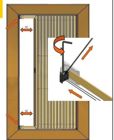
Spannen sie leicht die Schnur, und fixieren sie diese mit dem beigefügten Inbusschlüssel.
