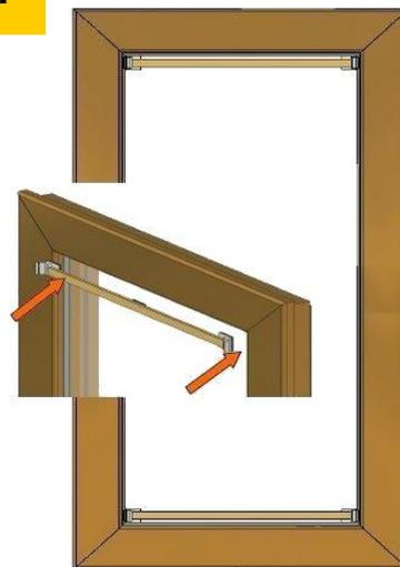
Entfernen sie vom Klettverschluss die Schutzfolie und kleben sie die Konsolhalterung in allen vier Ecken des Fensters.
