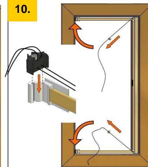
Ziehen sie die Schnur raus und platzieren sie diese auf der entgegengesetzten Seite In der frei gebliebenen Konsole.
