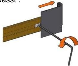
Sollte das Profil etwas kürzer sein, dann Schieben sie den Abstands Halter etwas weiter raus, und fixieren diesen dann gegen das verrutschen mit einem Inbusschlüssel
