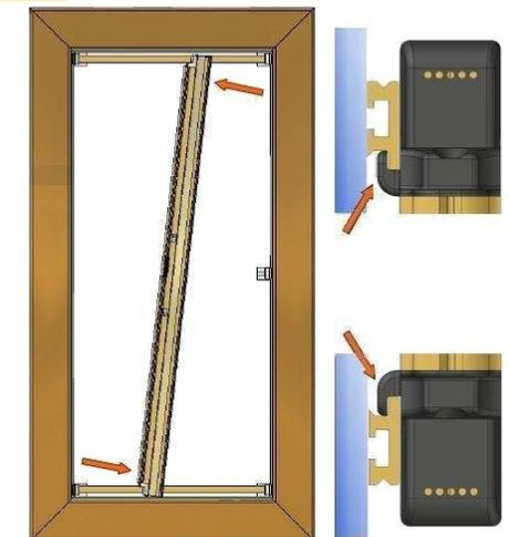
Nach der Fixierung der Schienen wird das Lapliss vorsichtig zwischen den oberen und unteren Konsolen platziert.
