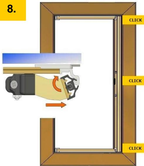
Den Sonnenschutz in die PVC Halterungen schieben und fixieren, bis diese einklicken.
